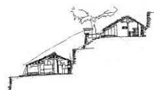
圖 5 石板屋掘山壁為背示意圖
